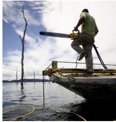
Der Einschnitt erfolgt mit pneumatisch angetriebenen Kettensägen.
